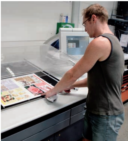
Der Farbton muss sitzen. Dies stellt der Drucker mithilfe von Prinect Image Control bei jedem Druckjob sicher.
